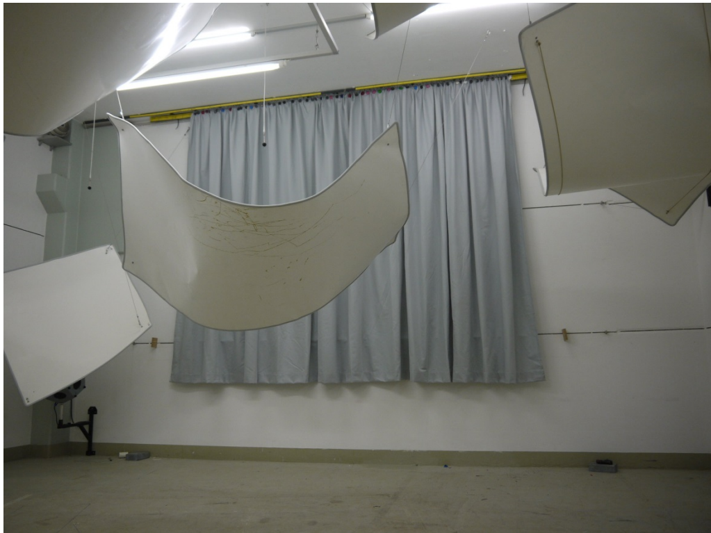
Abbildung B.1. Prüfanordnung im Hallraum (Ansicht).
