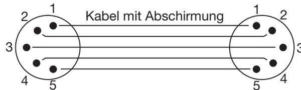
Der P3 verfügt über je zwei DMX-in und DMX-out Anschlüsse, die jeweils parallel durchverbunden sind. Benutzen Sie pro Scheinwerfer jeweils nur einen DMX-in und DMX-out Anschluss! Die Geräte können nicht als DMX-Splitter benutzt werden.
