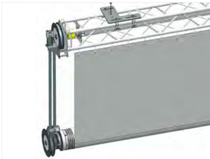
Seitliche Stahlband-Bobinen-Wickeleinheit aus Trag- und Sicherheitsband / Bobines latérales pour enroulement des bandes acier porteuses et de sécurité / Lateral steel belt bobbin winding unit made from brace and safety strap
